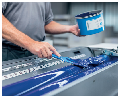
Ein Drucker der Firma PURe ink systems füllt reines Cyan-Blau in den Farbkasten der Druckmaschine. Bild: PURe ink systems
