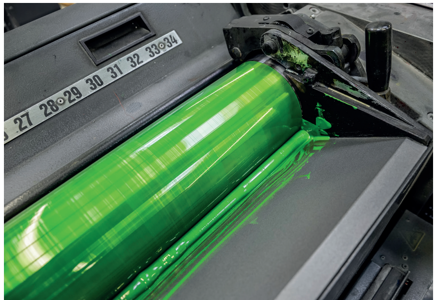
Grüne Farbe im Farbkasten einer Bogenoffsetmaschine. Die Walze ist die erste von mehreren Farbwalzen des Farbwalzenzuges. Bild: PURe ink systems
