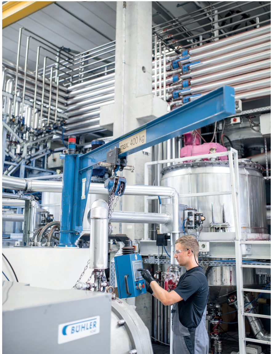
In der Produktionshalle in Neusäß bedient ein Mitarbeiter eine sogenannte Kugelmühle. Hier werden Pigmentagglomerate in den Farben verrieben. Bild: PURE ink systems
