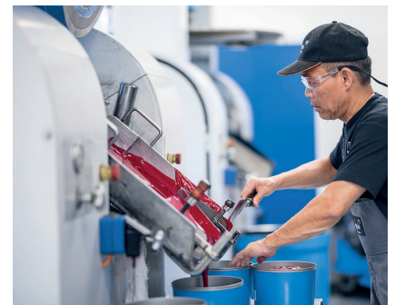
Ein Mitarbeiter der Firma PURe ink systems aus Neusäß füllt rote Farbe in 2,5-kg-Dosen ab. Bild: PURe ink systems
